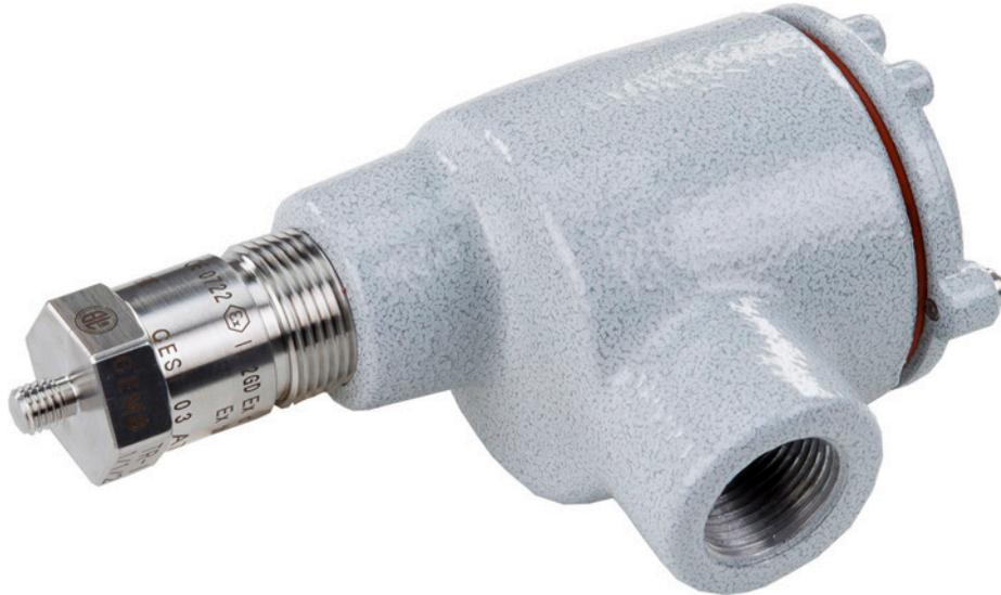
Il trasmettitore TR-I deve essere fissato nel punto dove si vogliono rilevare le vibrazioni, tipicamente sul supporto del cuscinetto di pompe, motori, ventilatori, ecc.
