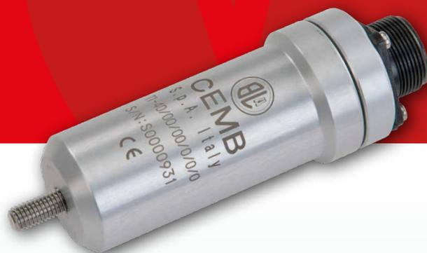
Il trasduttore T1-40 misura la vibrazione assoluta del supporto di qualsiasi macchina rotante. Fornisce una tensione proporzionale alla velocità di vibrazione direttamente interfacciabile ad un'apparecchiatura in grado di elaborarne il segnale (TR-V, TRAL-V, TM1, TDSP).
