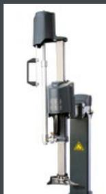
Versione con **posizionamento pneumatico del braccio porta utensile**.
