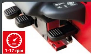
Versione dotata di **sistema Motoinverter** a DOPPIA velocità variabile con controllo di coppia che permette un risparmio di tempo di lavoro ed un risparmio energetico rispetto ai motori convenzionali.
