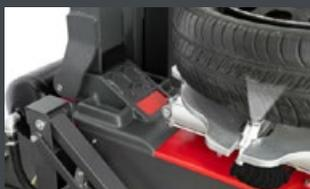
Versione dotata di efficace sistema di **gonfiaggio tubeless incorporato nelle griffe**, per l'intallamento del pneumatico.
