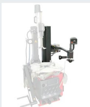
■ Pressore laterale professionale **HPX-ADVANCE** ideale per operare su ruote Run-Flat e UHP particolarmente duri e di grandi dimensioni. Struttura robusta progettata con 2 cilindri ad aria da 80 mm che non subiscono flessioni. Dotato di premicerchio, un rullo premitalone classico ed un rullo premitalone a 90° con bloccaggio pneumatico e possibilità di operare sul tallone inferiore.
