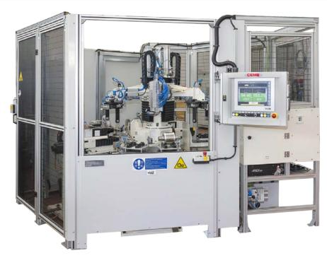
Impianto di equilibratura di rotori elettrici per autotrazione composto da tre stazioni, la prima di alloggiamento pezzo dove lo stesso viene posizionato manualmente o tramite robot.
