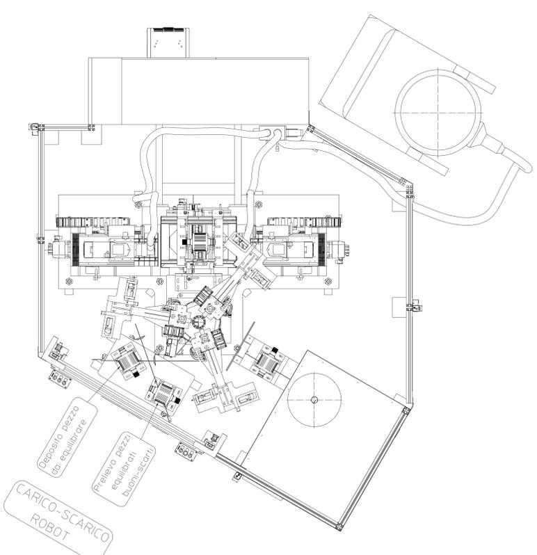
Deposito sia per pezzi non in tolleranza sia per pezzi con errori di lettura del datamatrix N.B. Sugli scarti di equilibratura verrà marcato il datamatrix e di fianco un puntino che identifica il pezzo scarto di equilibratura
